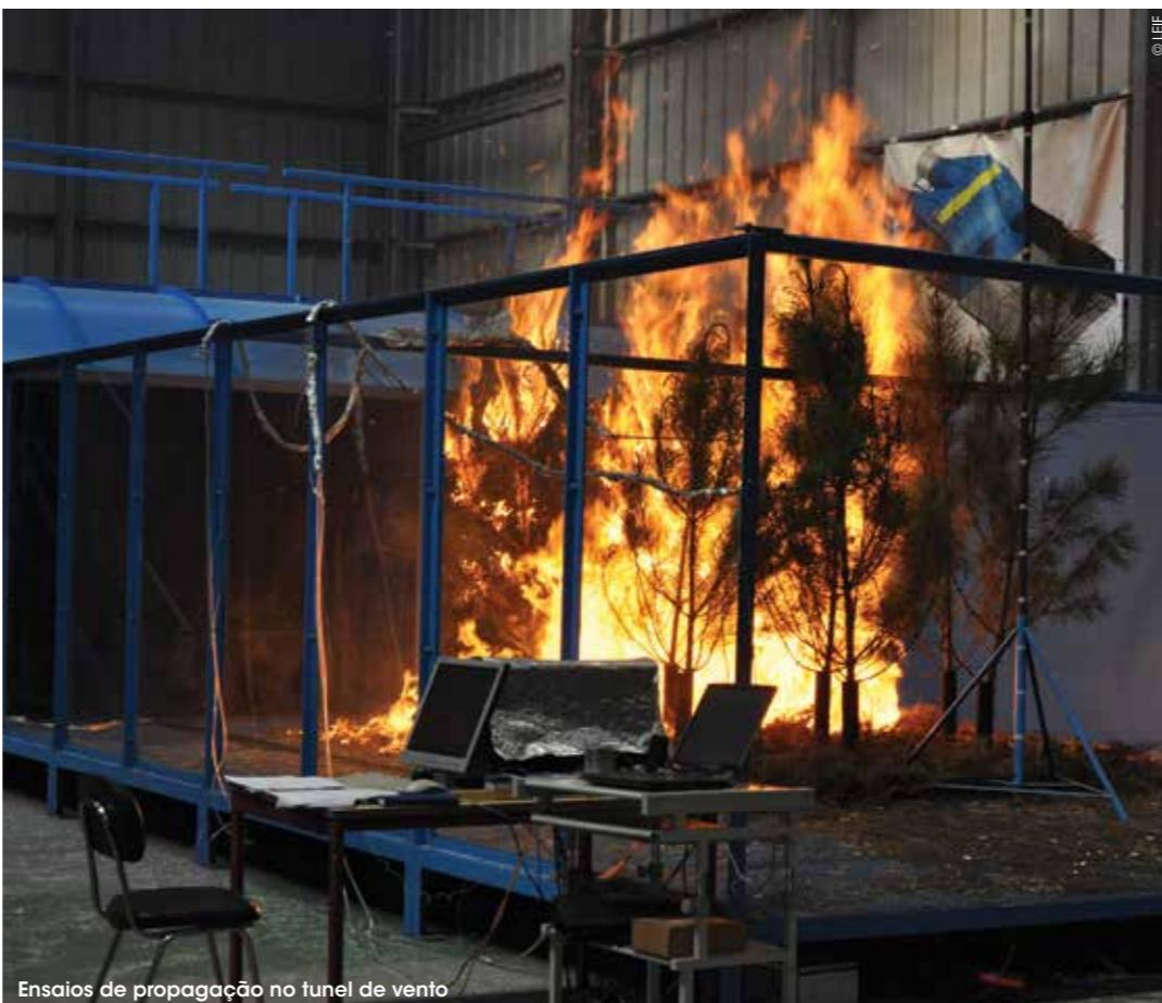
Ensaios de propagação no tunel de vento
